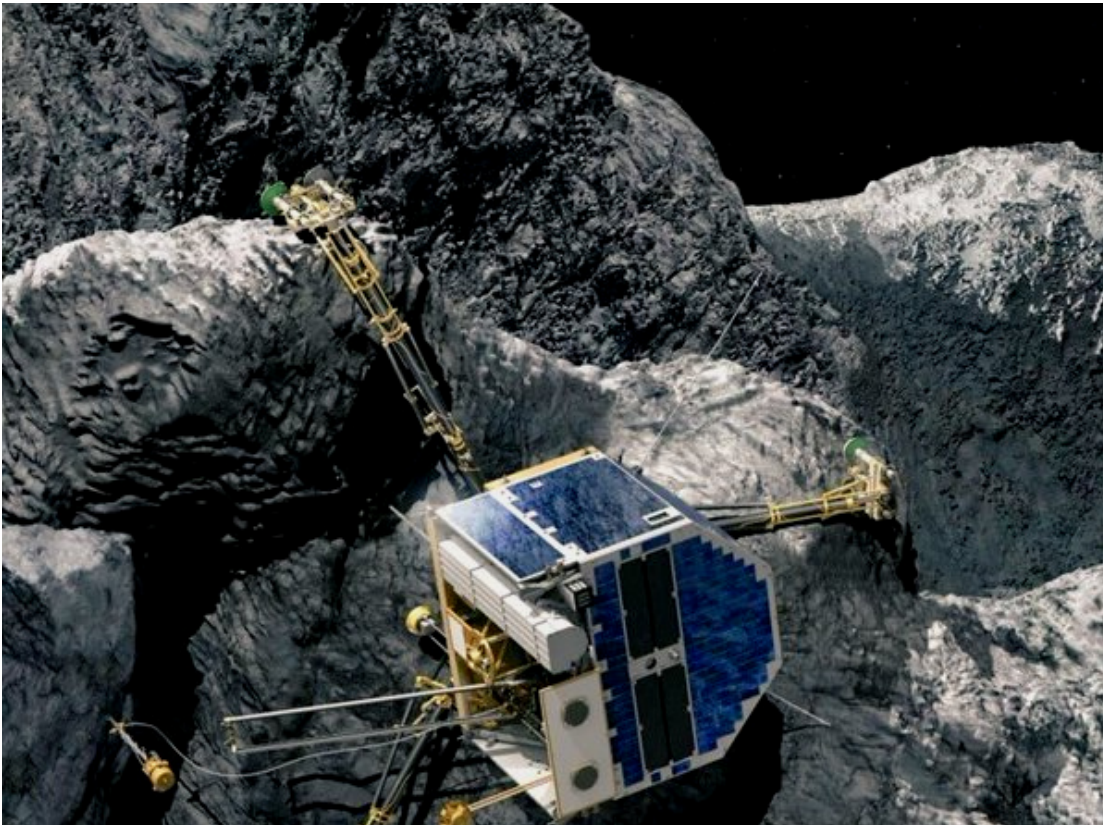
Abb. 3 Künstlerische Darstellung der Position des Kometenlanders Philae. Der Lander Philae befindet sich aufgrund technischer Probleme bei der Landung nicht am ursprünglich vorgesehenen Standort. Wahrscheinlich befindet er sich in einer Schiefelage an einem dunklen, von Felsen umgebenen Ort.
